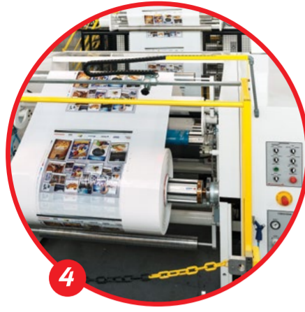
REBOBINAMENTO TIPO TROCA AUTOMÁTICA DE BOBINA - DESTAQUES EM ERGONOMIA E EFICIÊNCIA
