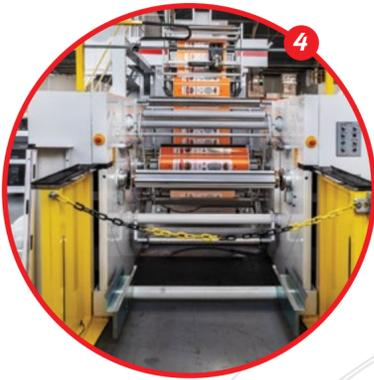
**REBOBINAMENTO TIPO TROCA AUTOMÁTICA DE BOBINA**
